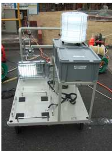
発電・照明ユニット
