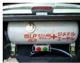
3: オートガス/DME 混合容器と専用スタンド設備
