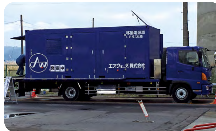
125KVA移動電源車。ローリー出荷にも対応。(エアウォーター(株)函館LPG基地にて)
