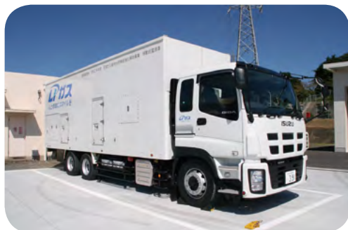
輸入基地での緊急時稼働用1,000KVA移動式電源車。 他基地に配備された移動式電源車の応援により 2台体制で出荷継続が可能。
