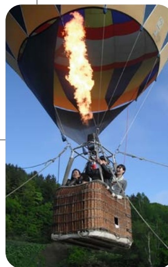
LPガスで気球内の空気を 温めて浮力をつけます。
