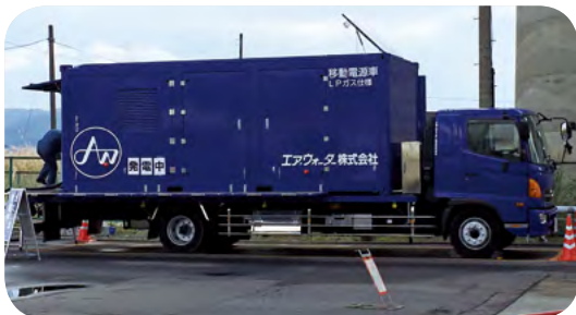
125KVA移動電源車。ローリー出荷にも対応。(エアウォーター(株)函館LPG基地にて)
