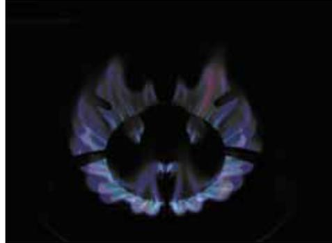
DME:プロパン = 8:2(気相中での割合)の燃焼状態の例
