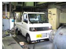
写真：排出ガス性能試験の様態とエンジンシステム
