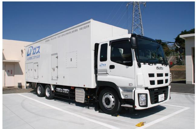
輸入基地での緊急時稼働用1,000KVA移動式電源車。
