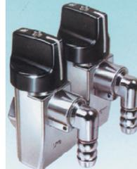
ヒューズガス栓とはガス器具の接続に使われるホースが外れたり、接続していない口を開ける等を行い、一度にガスが大量に流れる等の異常がおきると、自動的にガスを止める構造になっている安全構造型ガス栓のことです。
