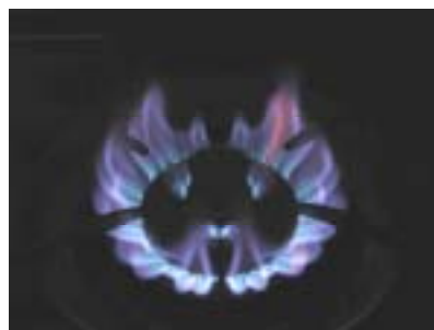
DME:プロパン=8:2 (気相中での割合)の燃焼状態の例
