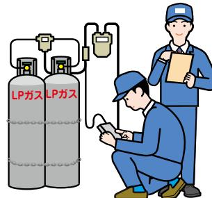
ガス漏れの有無、調整器・ガスマーター等の供給設備の点検を行います。
