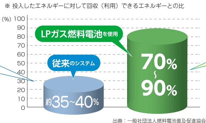
LPガスで発電する「エネファーム」は送電ロスがなくエネルギー効率は約70%以上に達するムダのない効率的なシステムです。
